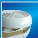
Вентилятор, оборудованный таймером и датчиком освещения включается при наличии освещения в помещении, а встроенный таймер обеспечивает работу вентилятора в течении 5 мин после выключения освещения (2-х проводная схема).
