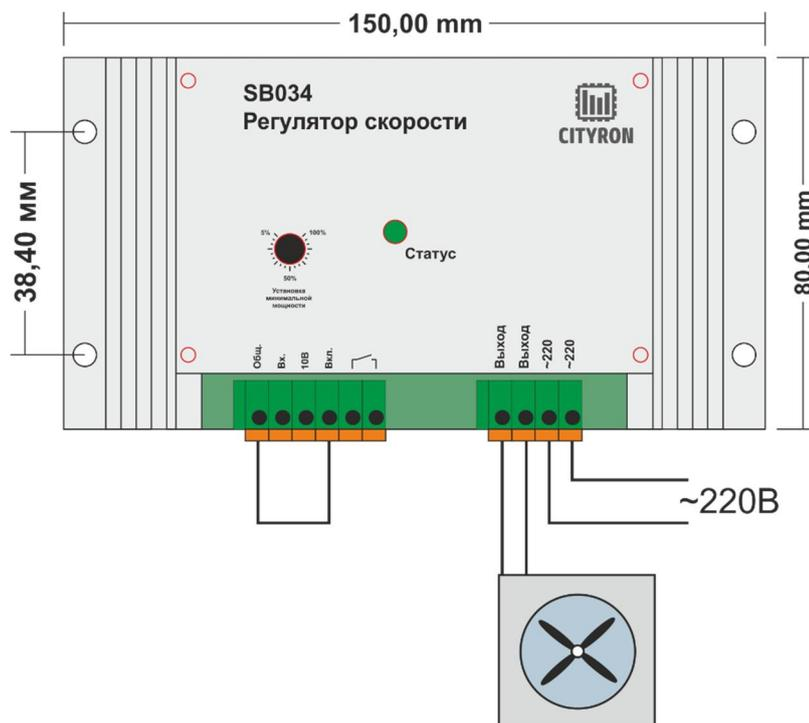
**Схема 2** Управление внешним сигналом от ручки управления SB006
