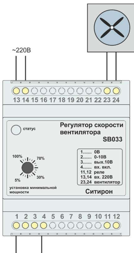
**Схема 1** Работа на фиксированной скорости, с обязательным использованием переключки между контактами 1 и 4
